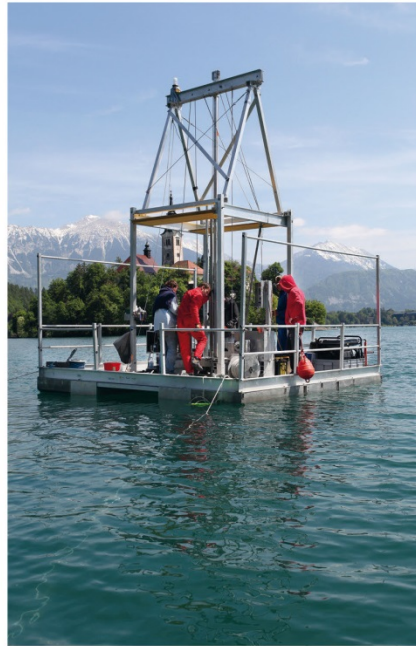
Sl. 11: Vrtanje sedimenta Blejskega jezera, ekipa Laboratoire des Sciences du Climat et de l'Environnement (LSCE, Francija) in Inštituta za arheologijo ZRC SAZU.
