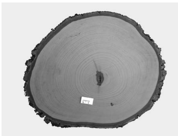
Sl. 8.12: Prečni prerez jesenovega debla. Osrednjemu delu, ki je na sliki temno obarvan in razpokan, so se pri izdelavi kolesa izognili, saj praviloma vsebuje les slabših lastnosti. Foto: M. Zupančič.
