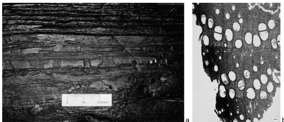
Sl. 8.37: Sledovi ožiganja - (a) površina lesa na notranji strani kolesne deske A1 (foto: M. Pflaum) in (b) mikroskopski pogled lesa, odvzetega s površine deske (foto: M. Zupančič); temnejši približno 0,5 mm debel sloj predstavlja pooglenelo lesno tkivo. Merilna daljica 100 \mu m.
