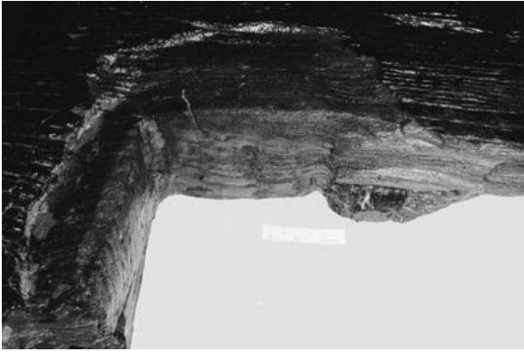
Sl. 8.38: Pesto na notranji strani kolesne deske A1 z obrabljenim delom, kjer je bilo kolo v stiku z osjo. Foto: M. Pflaum.
