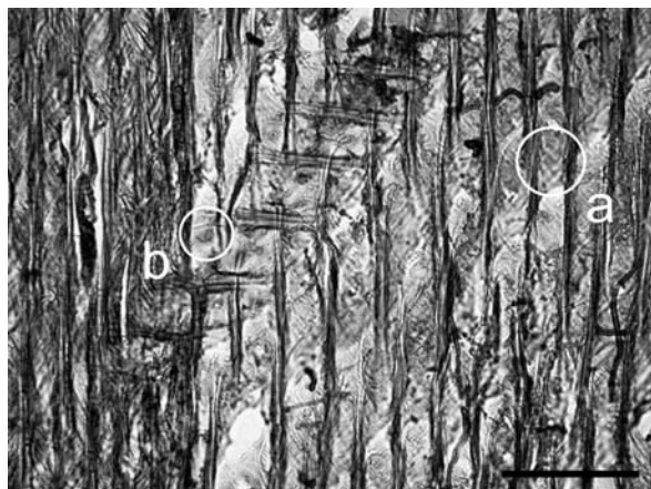
Sl. 10.10: Mikroskopska zgradba lesa loka iz tise ( Taxus baccata ). Vidne so traheide z deloma ohranjenimi helikalnimi (spiralnimi) odebelitvami (a) in kupresoidne piknje v križnih poljih (b). Foto: M. Zupančič. Merilna daljica = 50 \mu m.
