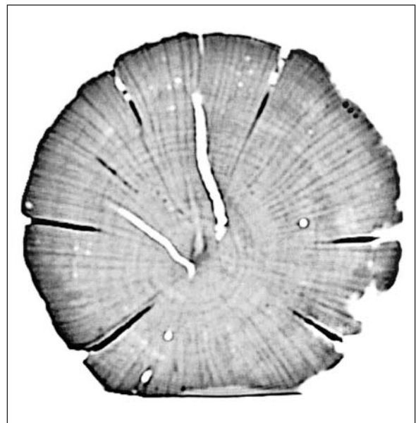
Sl. 8.24: CT prečnega prereza osi. Pripravil: M. Pflaum.
